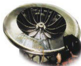
96" Titanium fan wheel
